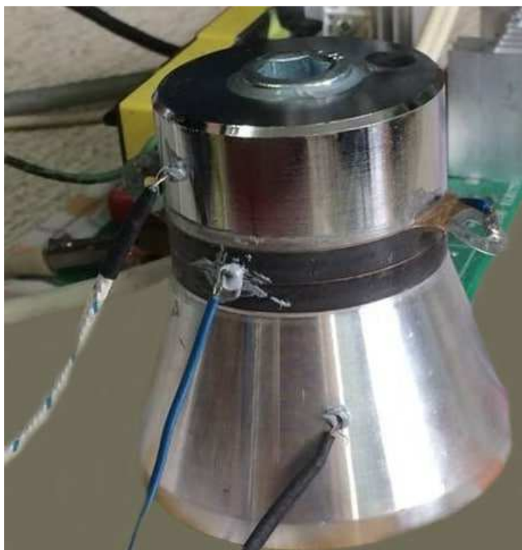
Рис. 3.9. Перетворювач типу Ланжевен
