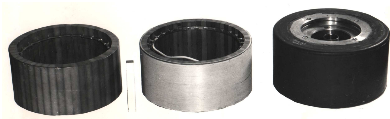
Рис.2.4 П'єзокерамічні електроакустичні перетворювачі циліндричного типу
